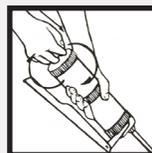
6. Para eliminar bolsas o burbujas de aire, abra la palanca al máximo y empuje con la mano el mango del vástago.
