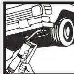
**Nota:** se recomienda angular la boquilla aproximadamente 10° con respecto al alineamiento para facilitar el ensamble y desensamble la boquilla.
